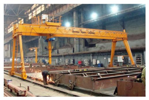
Сборочный портал (второй вид) для подачи и обжатия узлов при сборке крышек люковых закрытий. Внедрен в корпусном цехе в декабре 2019 года.
